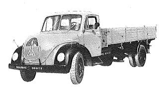
Diesel-Motor · 6 Zylinder · 4-Takt · 120 PS bei 2500 U/min
